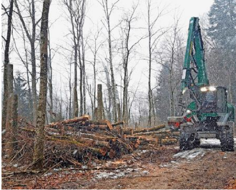
Dieser Raupenharvester, der einzige seiner Art in der Schweiz, schafft fast alles. Holzstämme greift er auf 15 Meter Distanz. Foto: PD
